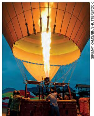
Maçarico aceso, aquecendo o ar no interior de um balão. (Laos, 2018.)
