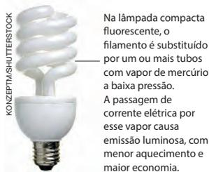
Na lâmpada compacta fluorescente, o filamento é substituído por um ou mais tubos com vapor de mercúrio a baixa pressão. A passagem de corrente elétrica por esse vapor causa emissão luminosa, com menor aquecimento e maior economia.
