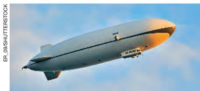
Um balão tripulado moderno. Um gás que não se inflama nem explode é usado no interior desse balão.
