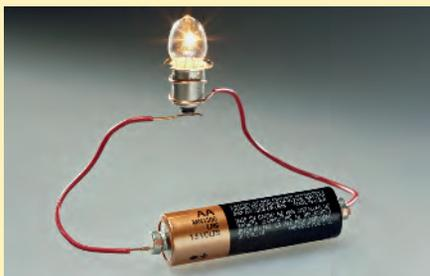
Nesse circuito elétrico, a energia potencial química da pilha é convertida em energia elétrica que, na lâmpada, é transformada em energia luminosa e energia térmica.
