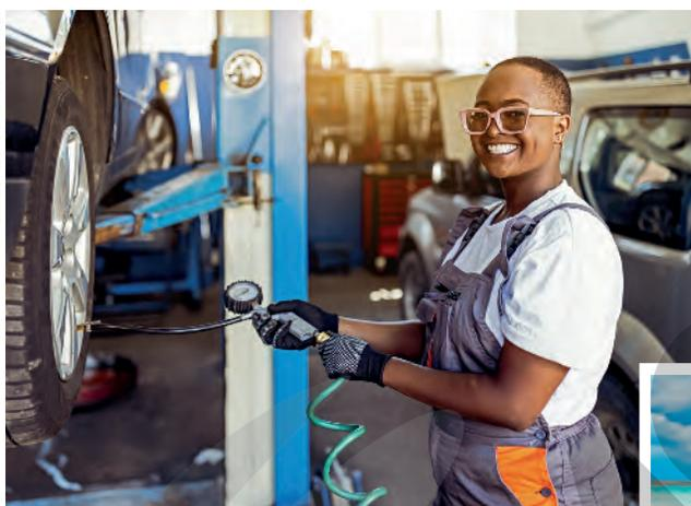
Manômetro sendo utilizado para calibrar pneu.
