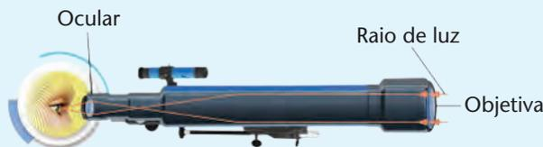
Corte transversal de um telescópio refrator.
