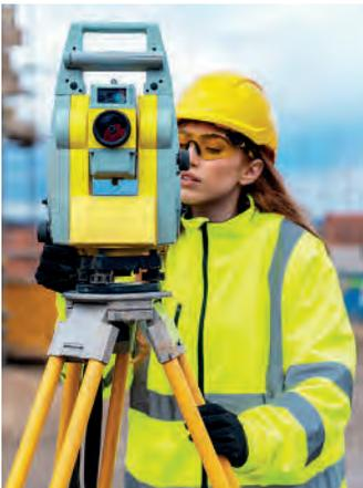
O teodolito é um instrumento usado na Topografia para medir ângulos.
