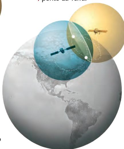
Quando um segundo satélite é detectado, o receptor calcula a distância até ele e uma segunda esfera é determinada. A intersecção da superfície dessa esfera com a da primeira é uma circunferência  $C_2$ , que intercepta a superfície da Terra em dois pontos distintos.
