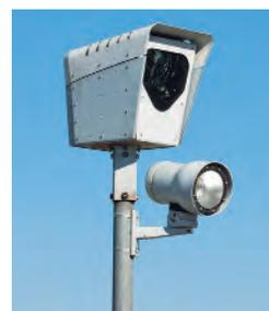
Radar medidor de velocidade.
