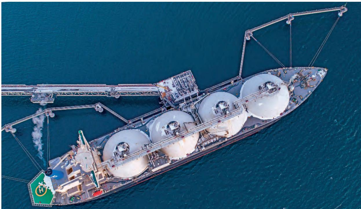
Transportador de gás natural liquefeito atracado em um terminal de abastecimento de gás. Na imagem, é possível ver parte do tanque esférico para armazenamento e transporte do gás. Foto de 2022.
